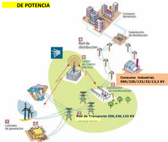
Fig. 1 SISTEMA ELECTRICO DE POTENCIA
