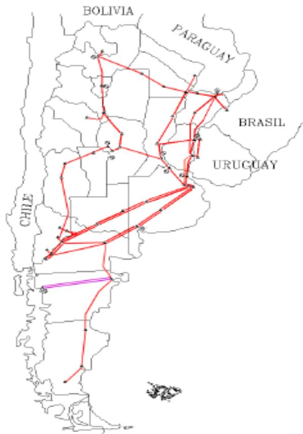
**La tendencia es la normalización de las tensiones de Transporte, a 500 kV (EAT), 132kV (AT) y 13,2kV (MT), aunque en sistemas rurales y algunas provincias seguirán persistiendo líneas de subtransmisión de 33 kV (MT). También en el futuro argentina deberá revisar las tensiones de Transporte y si serán de HDC. (Corriente continua en alta tensión)**
