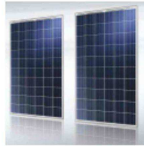
Modulos de 60 células con un total de 240 Wats de silicio policristalinos, eficiencias del 12 al 13%
