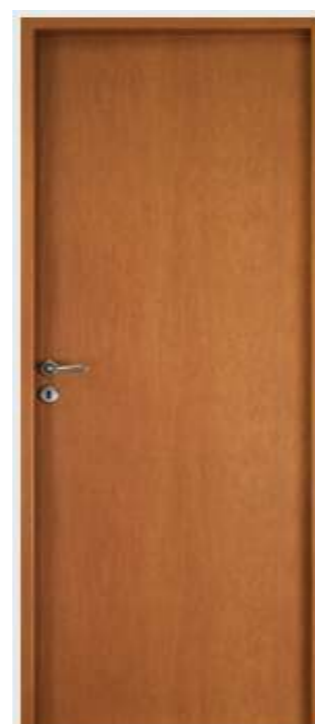
Puerta placa línea Práctika Enchapada en MDF y foliada en 2 colores (Curupí o Blanco) – Viene con marco de madera, chapa o aluminio – Opcional para marco de madera, contramarco de MDF foliado con la misma terminación – Estructura interna de madera maciza con panel celulósico tipo nido de abeja
